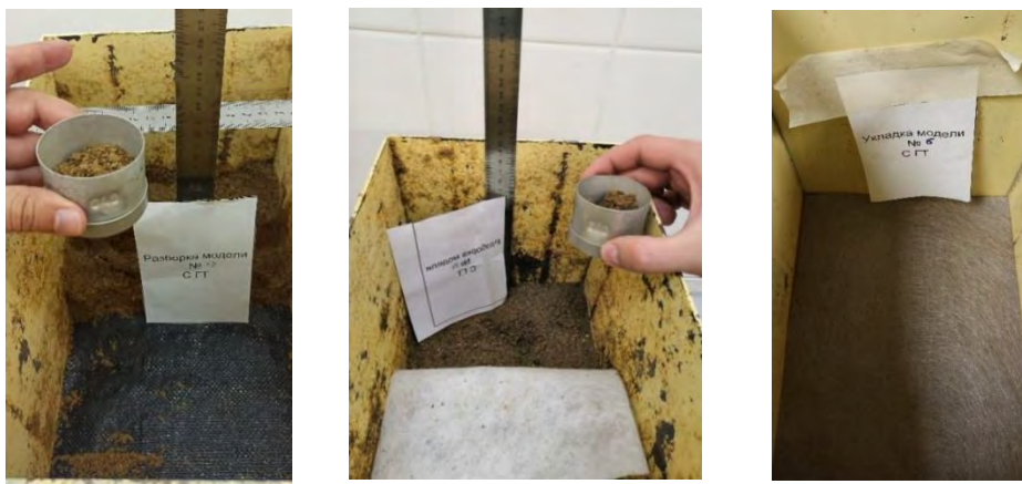
Рис. 3. Разборка и укладка разделяющей прослойки
