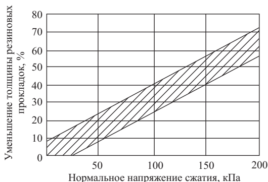
Рисунок А.2 – Диаграмма зависимости уменьшения толщины пористой резиновой прокладки с закрытыми порами от нормального напряжения сжатия
