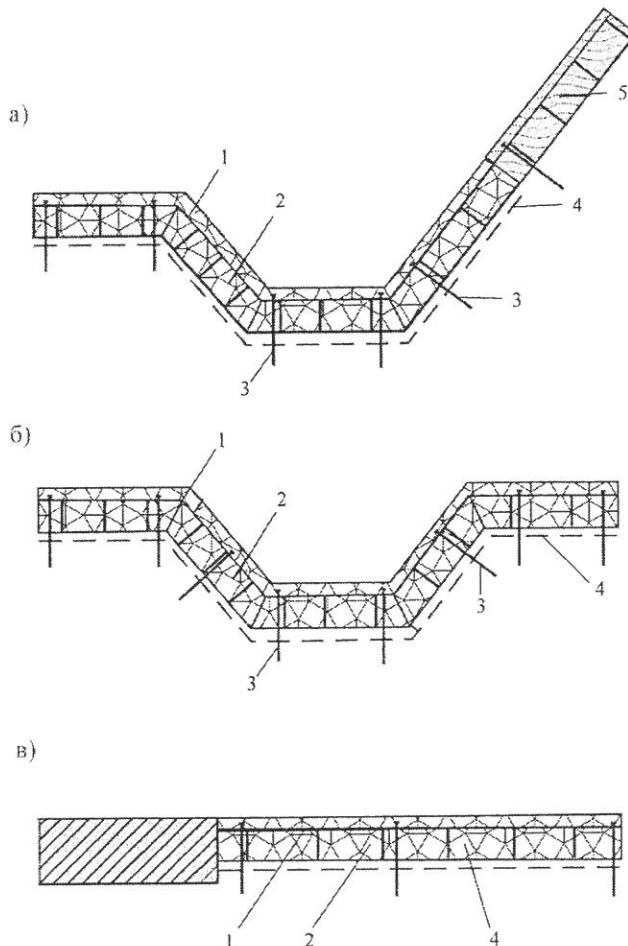
креплении геосот следует руководствоваться положениями пункта 6.1.2, дополняя крепление установкой анкеров в местах перелома продольного профиля канав (куветов). Краевые части геосот должны быть выведены за пределы бровок кюветов (водоотводных канав) и надежно закреплены.
