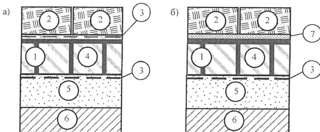
1 – геосоты; 2 – бетонные плиты; 3 – разделяющий слой из геотекстильного материала; 4 – заполнитель геосот (песок, щебень, гравий, шлак, песчано-гравийная смесь), в том числе укрепленный вяжущим (при соблюдении положений пункта 6.2.4 в части конструктивного решения, приведенного на рисунке 8,в); 5 – песчаный дренирующий слой; 6 – грунт земляного полотна; 7 – монтажный слой из пескоцементной смеси
