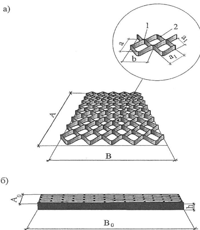
1 – сварные швы; 2 – геополосы; А, В – соответственно длина и ширина модуля (А – направление растяжения);  $A_0$ ,  $B_0$  – соответственно длина и ширина пакета; а, б – соответственно размер ячейки по диагоналям в направлении длины и ширины;  $a_1$  – размер стороны ячейки;  $h$  – высота геосот (ширина геополосы)
