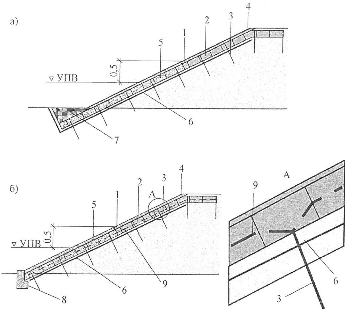
1 – геосоты; 2 – растительный грунт; 3 – анкер; 4 – защитный слой толщиной 3–5 см над геосотами из материала заполнителя геосот; 5 – укрепленный грунт, бетонная смесь и др.; 6 – защитная прослойка из нетканого геотекстильного материала; 7 – каменная засыпка; 8 – бетонный упор; 9 – трос
