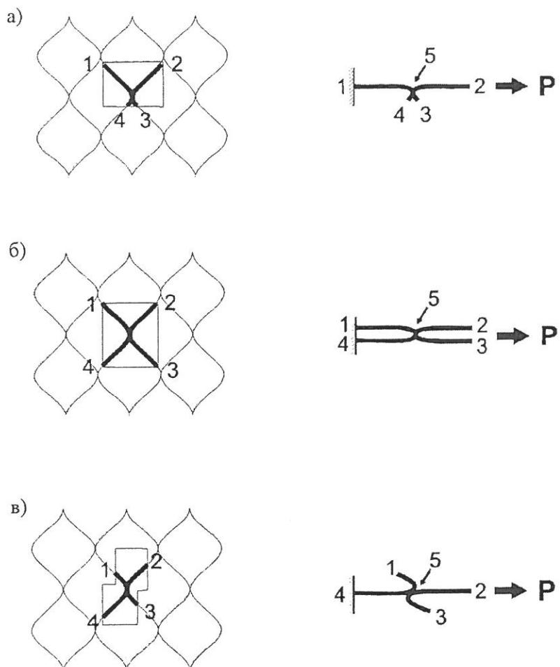
1–4 – расположение геополос при отборе из модуля и проведении испытаний (обозначения 1, 4 и 2, 3 относятся к одной геополосе);
