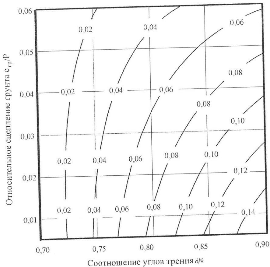
Рисунок В.2 – Номограмма для определения максимального значения поправки  $\Delta_{\text{трēн}}^{\text{max}}$  на соотношение углов трения  $\delta/\phi$
