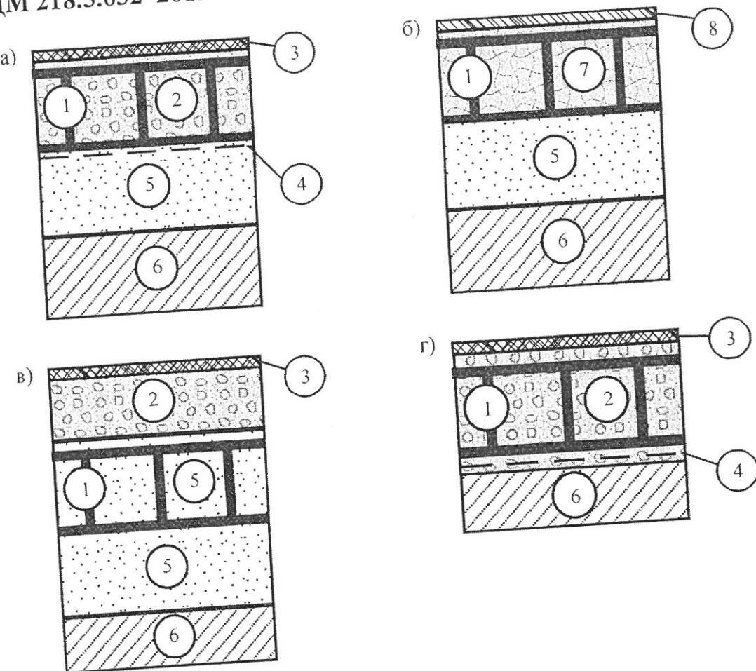
1 – геосоты; 2 – крупнофракционный материал (щебень, гравий, шлак, щебеноочно-песчано-гравийная смесь); 3 – поверхностная обработка; 4 – разделяющая прослойка из геотекстильного материала; 5 – дополнительный слой основания (песок); 6 – грунт земляного полотна; 7 – песчаный грунт или местный грунт, обработанный вяжущим; 8 – защитный слой из втапливаемого щебня
