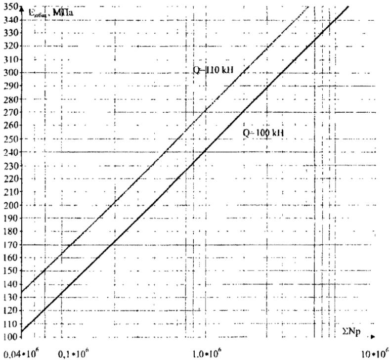
**Рисунок 6.4.** Зависимость общего расчетного модуля упругости конструкции  $E_{общ}$  от суммарного расчетного числа приложений нагрузки за расчетный срок службы,  $\Sigma N_p$ ,  $Q$  – нормативная статическая нагрузка на ось расчетного автомобиля (к п. 6.2.8)
