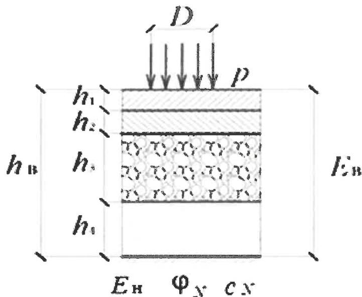
$h_b$  — верхний слой конечной толщины;  $E_b$  — модуль упругости верхнего слоя;  $E_n$  — модуль упругости упругого полупространства, неограниченного снизу (нижнего слоя);
