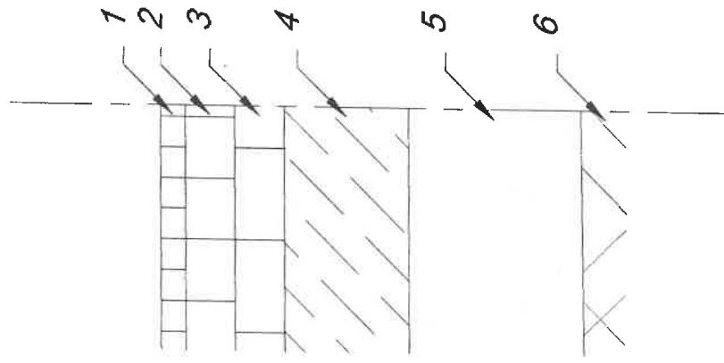
1 – ВСП; 2 – НСП; 3 – ВСО (необходимость устройства на дорогах категории IV обосновывается результатами расчета); 4 – слой основания; 5 – дополнительный слой основания; 6 – грунт рабочего слоя земляного полотна
