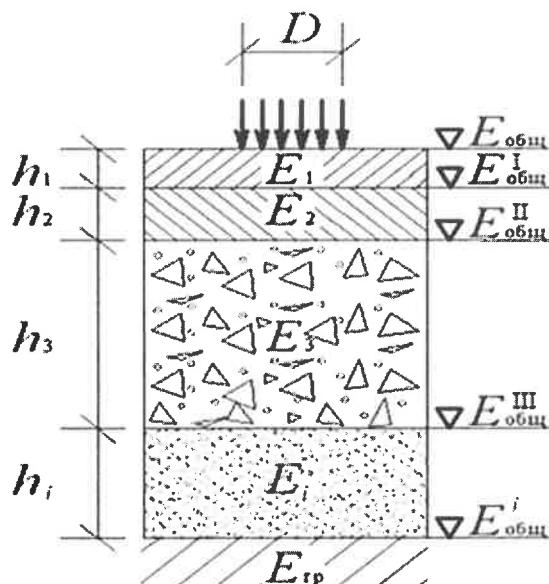
$h_1, h_2, h_3, h_i$  – толщины слоев;  $E_{\text{общ}}$  – общий модуль упругости дорожной одежды;  $E_{\text{общ}}^1, E_{\text{общ}}^2, E_{\text{общ}}^3, E_{\text{общ}}^i$  – общие модули упругости на поверхности слоев;  $E_1, E_2, E_3, E_i$  – локальные модули упругости.
