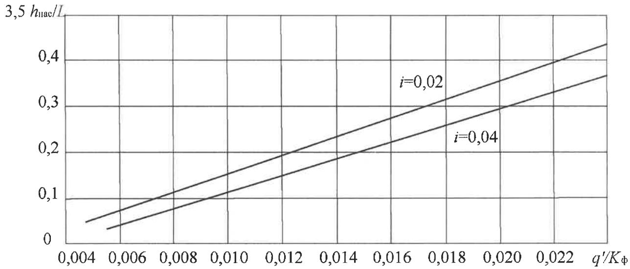
$i$  — поперечный уклон низа дренирующего слоя;  $L$  — длина пути фильтрации;
