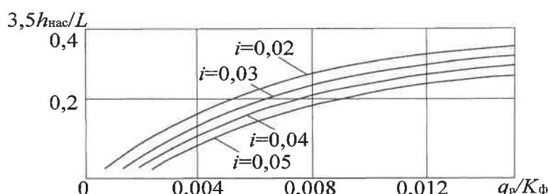
$i$  – поперечный уклон низа дренирующего слоя;  $L$  – длина пути фильтрации;
