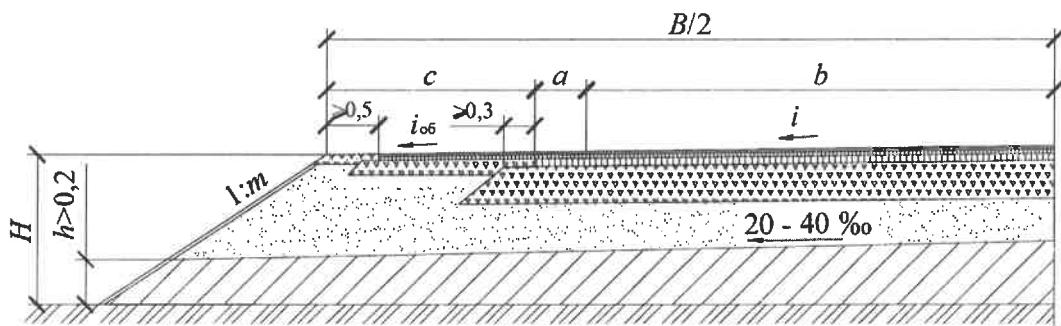
*а – устройство дренирующего слоя на всю ширину земляного полотна*
