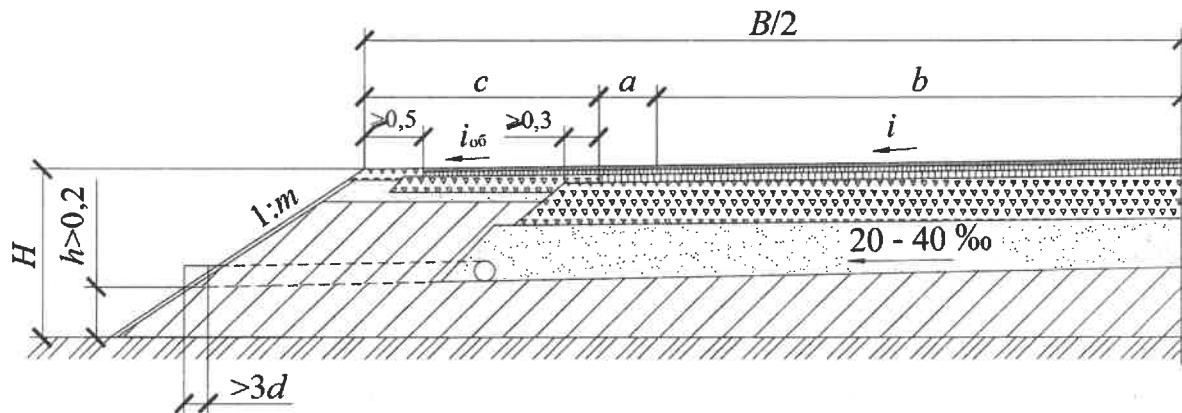
*б – устройство дренирующего слоя на ширину проезжей части и краевых полос с отводом воды по дренажным трубам*
