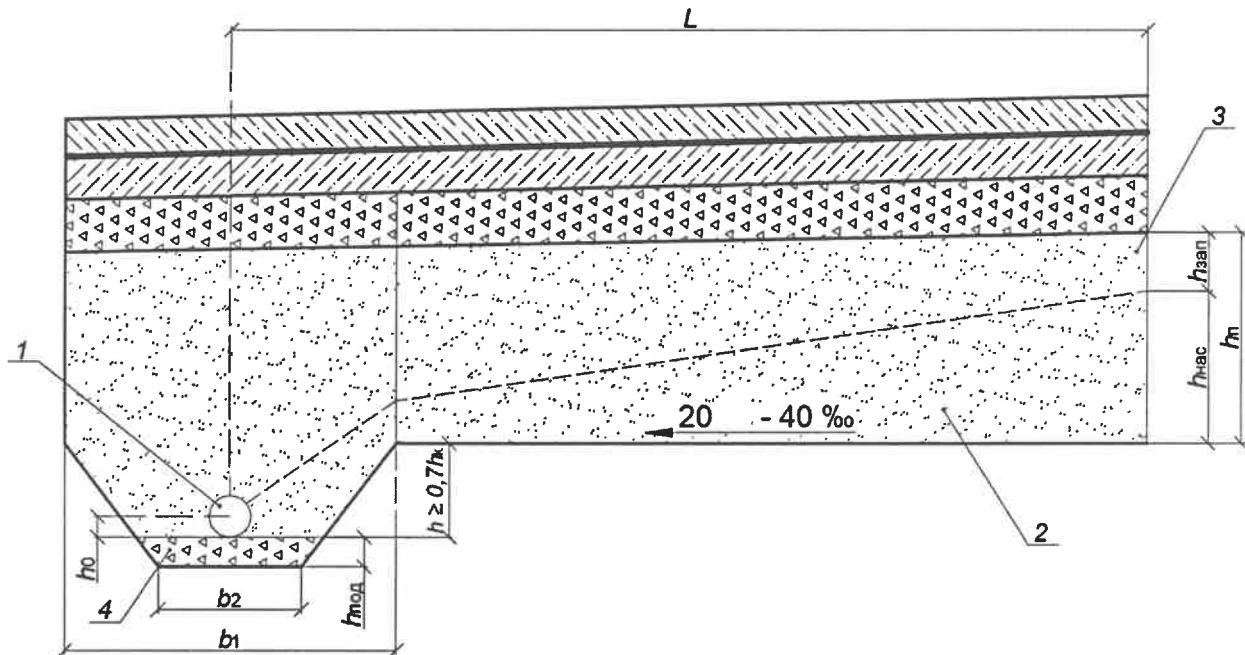
1 – дренажная труба; 2 – зона движения свободной воды; 3 – зона движения капиллярной воды; 4 – щебеночная (песчаная) подготовка под дренажную трубу;
