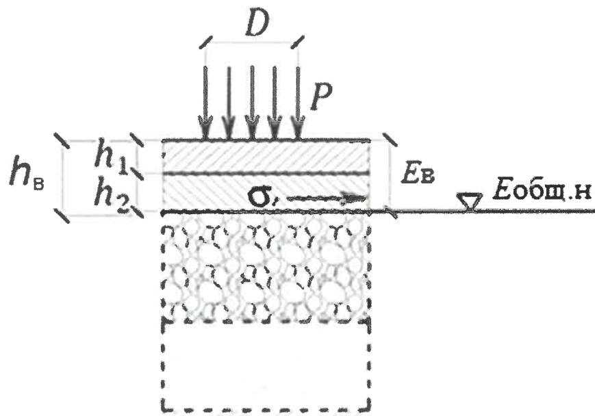
$h_v$  – верхний слой расчетной модели;  $h_1$ ,  $h_2$  – толщины отдельных слоев асфальтобетона;  $E_v$  – средневзвешенный модуль упругости верхнего слоя;  $E_{общ.н}$  – модуль упругости упругого полупространства, ниже пакета слоев из асфальтобетона неограниченного снизу (нижнего слоя)
