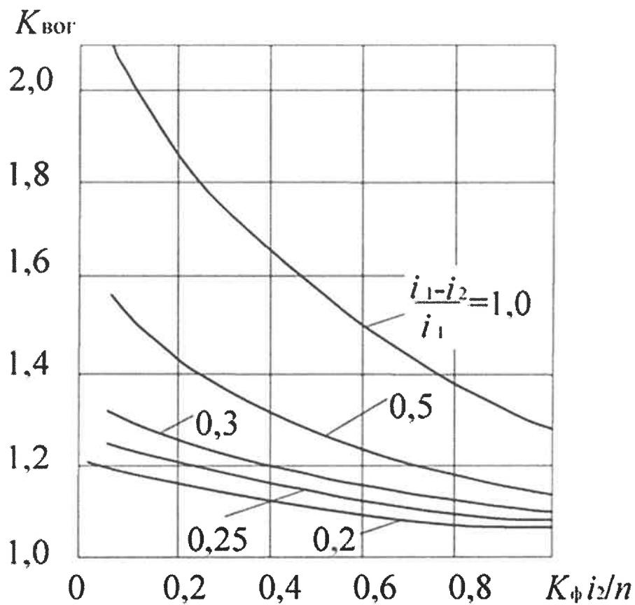
$i_1$  и  $i_2$  – продольные уклоны выше и ниже перелома продольного профиля;  $K_{\Phi}$  – коэффициент фильтрации, м/сут;  $n$  – пористость дренирующего слоя в долях единицы (значения уклонов принимают по абсолютной величине)
