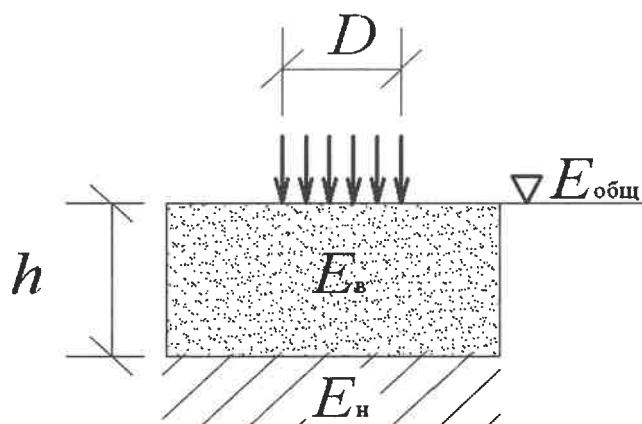
$h$  – верхний слой конечной толщины;  $E_v$  – модуль упругости верхнего слоя;  $E_n$  – модуль упругости упругого полупространства, неограниченного снизу (нижнего слоя);
